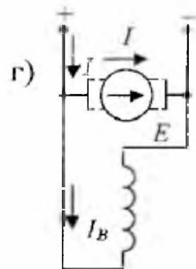
9. Если естественная механическая характеристика двигателя постоянного тока параллельного возбуждения - прямая А, то группе искусственных характеристик Б соответствует способ регулирования частоты вращения ротора изменением:
